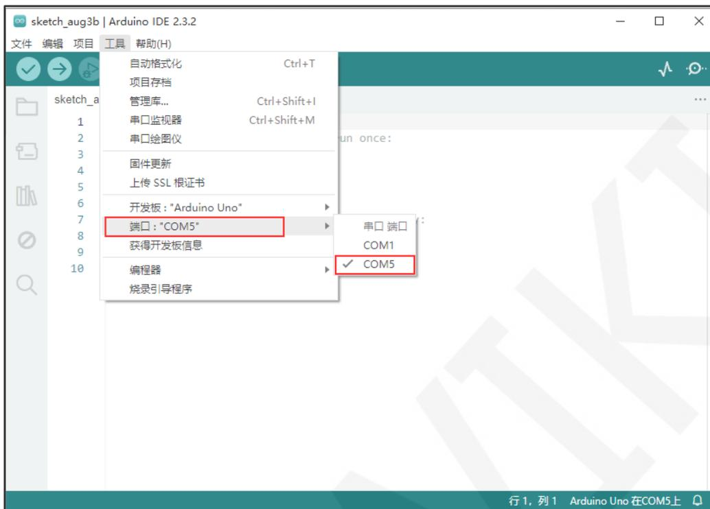
图 3.11 Arduino IDE2 端口选择
