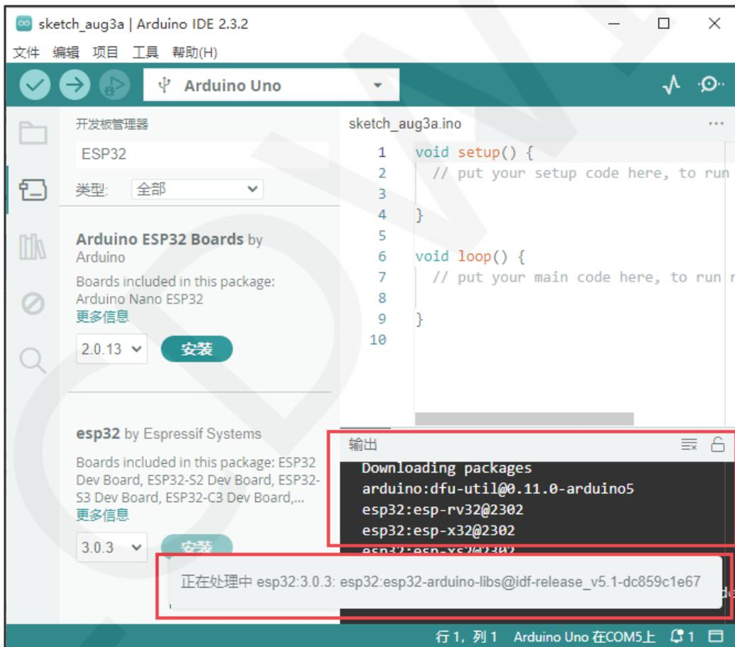
图 4.2 Arduino-ESP32 核心软件库安装
