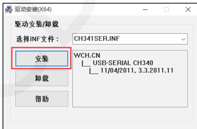
图 5.1 CH340C 驱动安装
