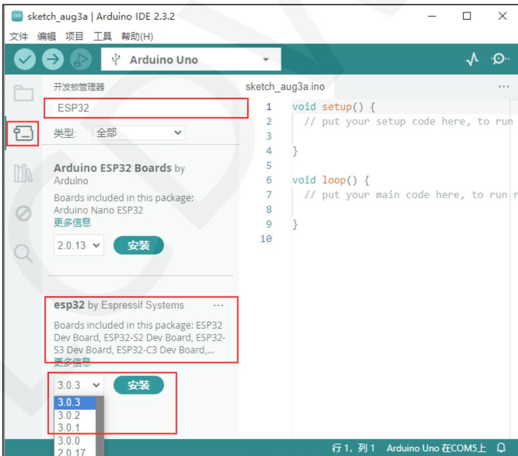
图 4.1 Arduino-ESP32 核心软件库搜索
