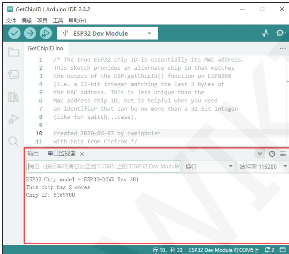
图 5.9 ESP32 程序串口输出
